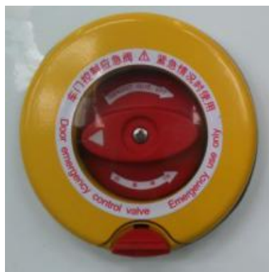
图 8.5.1.1 乘客门应急控制阀
