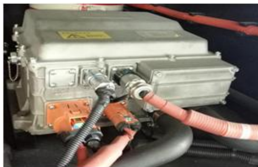
图 6.2.6.1 集成式辅助变流器
