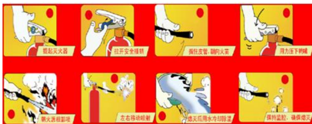
图 8.1.2 手持灭火器使用方法
