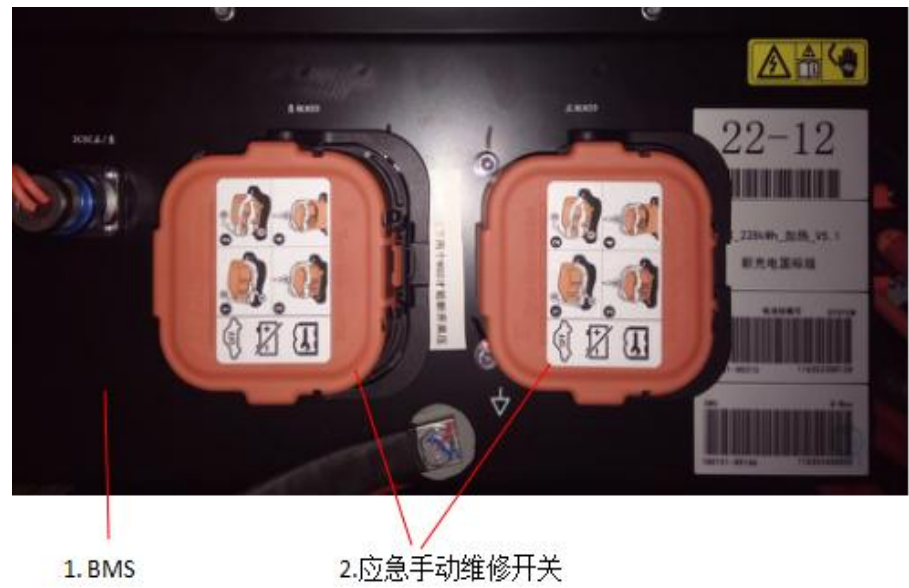
图 6. 2. 3. 1 BMS 及维修开关位置
